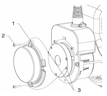
Figure 3-11. Manual Disengage
